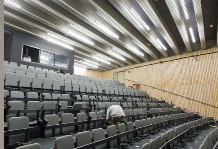
Dans les amphithéâtres, l'acoustique est traitée grâce à des fibres de bois mais aussi le rythme des poutres et le placage des murs en érable.
