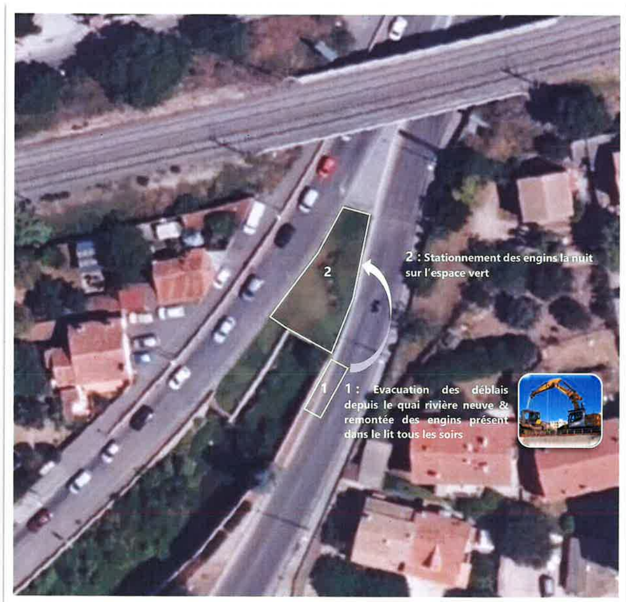
FIGURE 8 : METHODOLOGIE EMPLOYEE PAR L'ENTREPRISE LORS DE LA PHASE TRAVAUX
