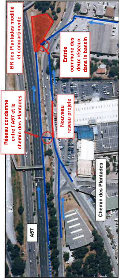
Figure 6 : Synoptique du réseau pluvial en amont du bassin de rétention des Plantades, à l'état projet
