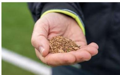
La Métropole a engagé depuis 2020 un passage progressif des remplissages des terrains synthétiques en matières organiques. En effet, traditionnellement en caoutchouc (pneus recyclés), la Métropole a fait le choix, dans le cadre d'une phase de réhabilitation globale de ses terrains, d'opter pour des matériaux de remplissage naturels et durables tels que le noyau d'olive, le liège et la fibre de noix de coco. À ce jour, trois terrains ont été réhabilités, et deux autres le seront en 2024 et 2025.
