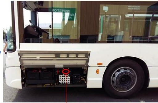
Sur GX337, prise de charge situé à l'avant gauche du véhicule
